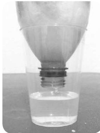
**5.** Das Wasser sickert durch alle Schichten und tröpfelt nach kurzer Zeit sauber gefiltert in den Becher.
