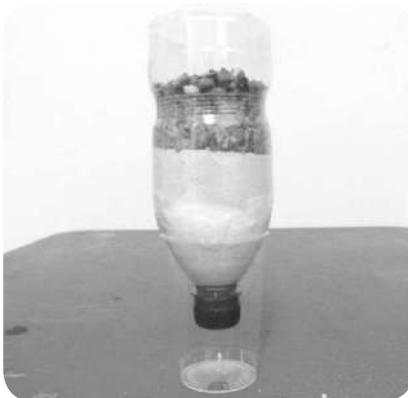
**2.** Zuerst gibst du die Watte in die Flasche. Schüttele dann langsam den Sand auf die Watte und gib die Kieselsteine auf die Sandschicht. Dein „Waschfilter“ ist nun fertig und besteht aus drei Schichten: Watte, Sand und Kies.
